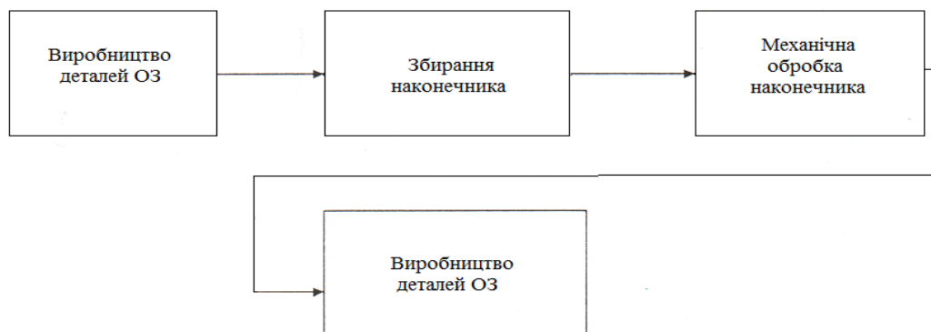
Рисунок 3 - Загальна схема виготовлення ОЗП
