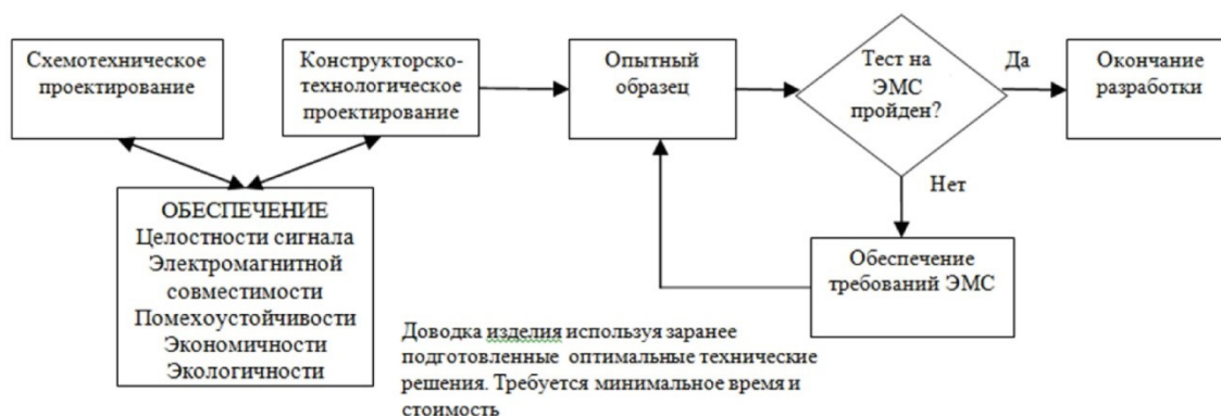
Рисунок 2 – Комплексный подход при проектировании, учитывающий требования ЭМС
