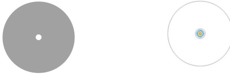
Рисунок 3 – Одномодове ОВ з радіусом серцевини r = 5 \mu\text{мкм} та розподіл поля основної моди на довжині хвилі \lambda = 1,55 \mu\text{мкм}
