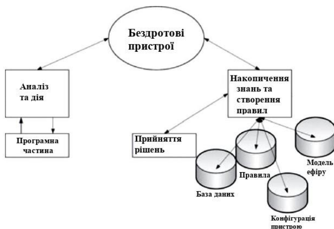
Рис.1. Система динамічного доступу до спектру з використанням бази даних
