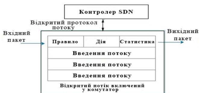
Рис.2. Модель switch OpenFlow
