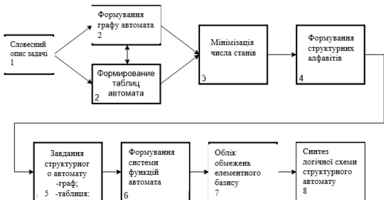
Рис. 7.26 – Процес синтезу схеми цифрового автомата
